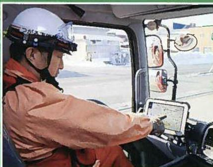
目的地点へのナビゲーションだけでなく、指令室や他車両との情報共有・各種連携をこなすタブレット型車両運用端末装置です。
